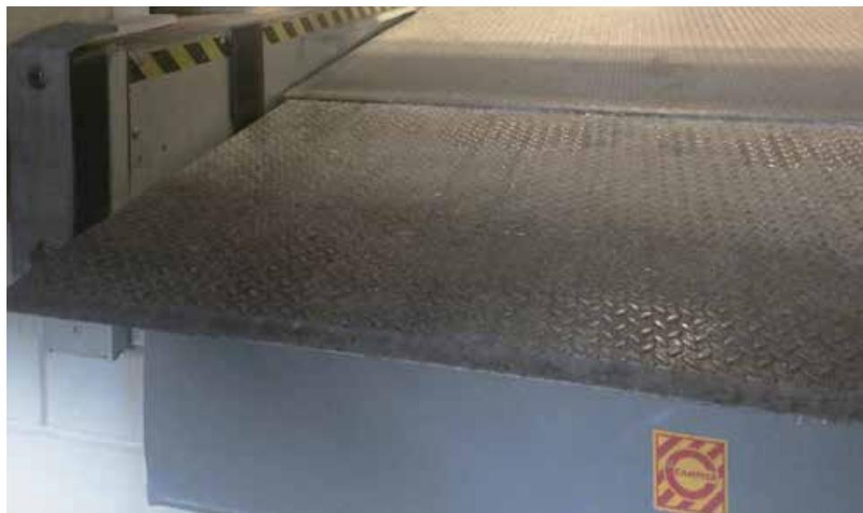
Le rampe con becco telescopico sono ideali per raccordare mezzi che non possono accostarsi a filo banchina (ad es. containers, carichi laterali, vagoni ferroviari ecc.) o nel caso sia necessaria una maggiore lunghezza totale del ponte di raccordo.
