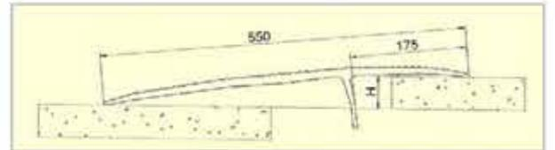
**Pedane tipo KB in lega leggera:** sono pedane scorrevoli entro una rotaia in acciaio saldata a filo banchina. A riposo sono posizionate in verticale, assicurate contro l'eventuale caduta da un fermo meccanico (EN 1398), ma possono anche essere riposte in verticale sotto filo banchina. Causa il limite di sforzo di sollevamento ergonomico di 25 kg le KB sono disponibili fino alla dimensione massima indicata. Maggiori dimensioni richiedono un bilanciamento ed è necessario passare alla Gliss.
