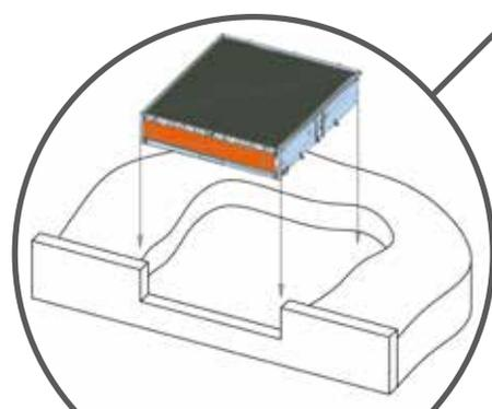
**CAST:** applicazione per rampa finita con telaio. Da livellare a quota pavimento finito e cementare.
