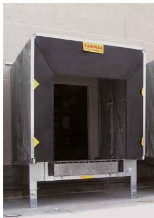
*Le Dock House con Rampa Telescopica Recessa, con pannelli isolanti da 80 mm e con Sigillanti Gonfiabili consentono il massimo risparmio energetico e sono particolarmente adatte per il grande freddo.*
