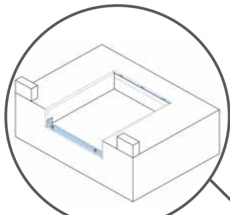
**STAR:** applicazione per fossa costruita in edilizia tradizionale. Fissaggio trave anteriore mediante tassellatura e saldatura cerniere posteriori.
