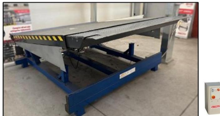
Figura 1: Immagine reale rampa con becco telescopico e consolle di comando
