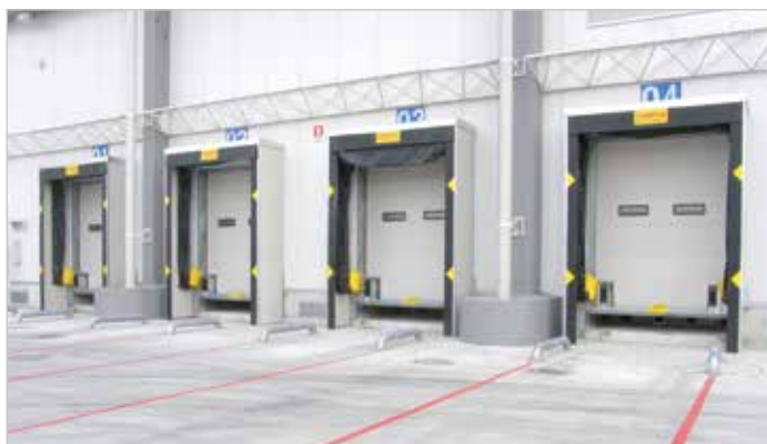
Il massimo dell'isolamento: Baia Recessa e Sigillante Gonfiabile. Guida ruote a protezione delle fiancate del Sigillante
